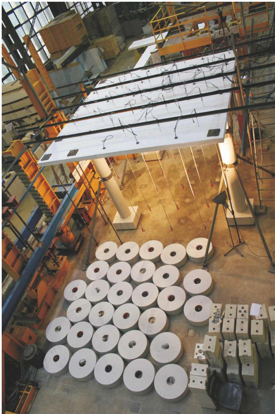
Rys. 10. Widok pierwszej warstwy obciążników tuż przed podwieszeniem.
