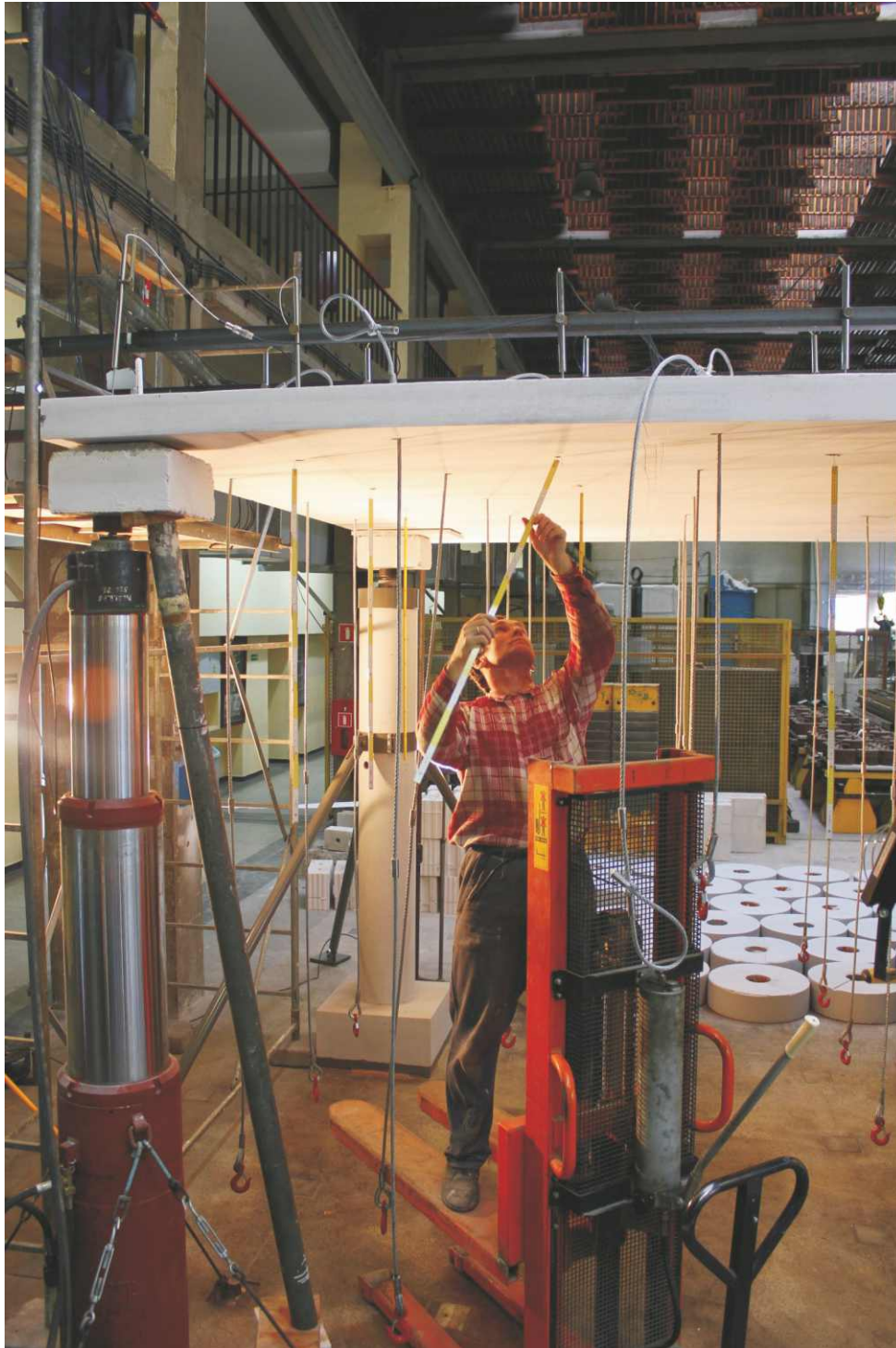
Rys. 17. Mocowanie taśm umożliwiających pomiar geodezyjny.
