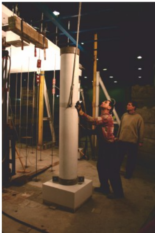
Rys.35. Przebieg badań – usuwanie podpory.
