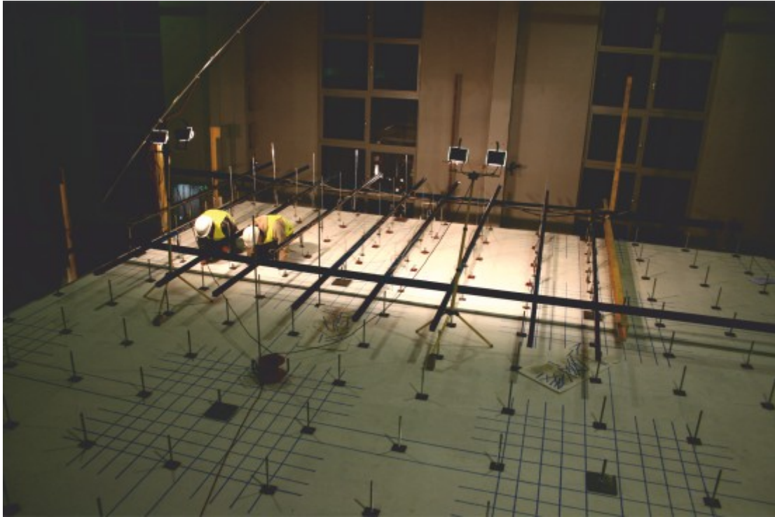
Rys.37. Przebieg badań – odwzorowywanie zarysowań na górnej powierzchni modelu.
