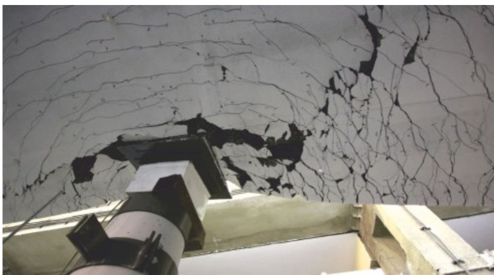
Rys.67. Szczegóły zniszczeń Modelu 2 – widok strefy podporowej (opis w tekście).
