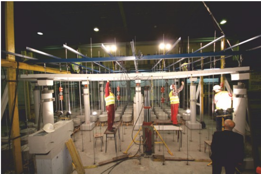
Rys.38. Przebieg badań – odwzorowywanie zarysowań na dolnej powierzchni modelu.
