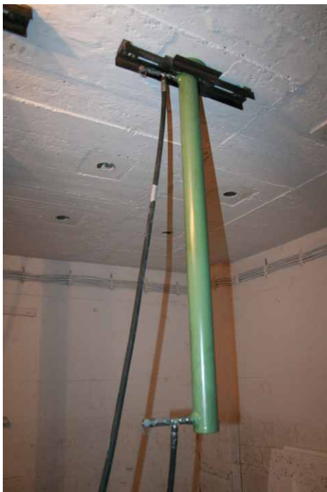
Rys. 30. System obciążania hydraulicznego w drugim etapie badań - obwód wewnętrzny:
