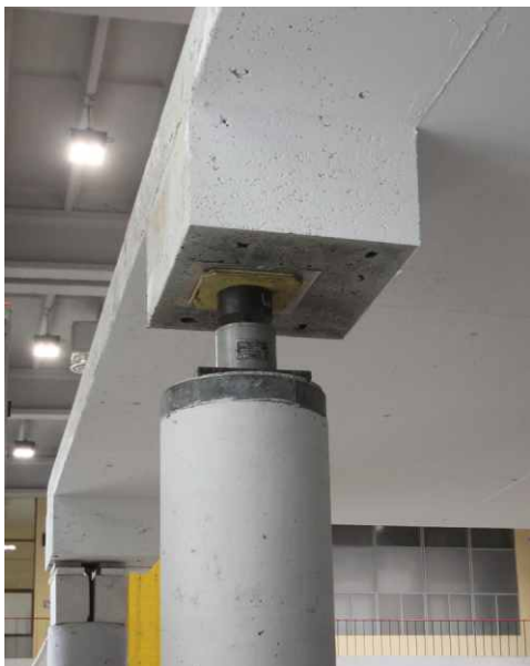
Rys. 23. Zdjęcia podparcia modelu
