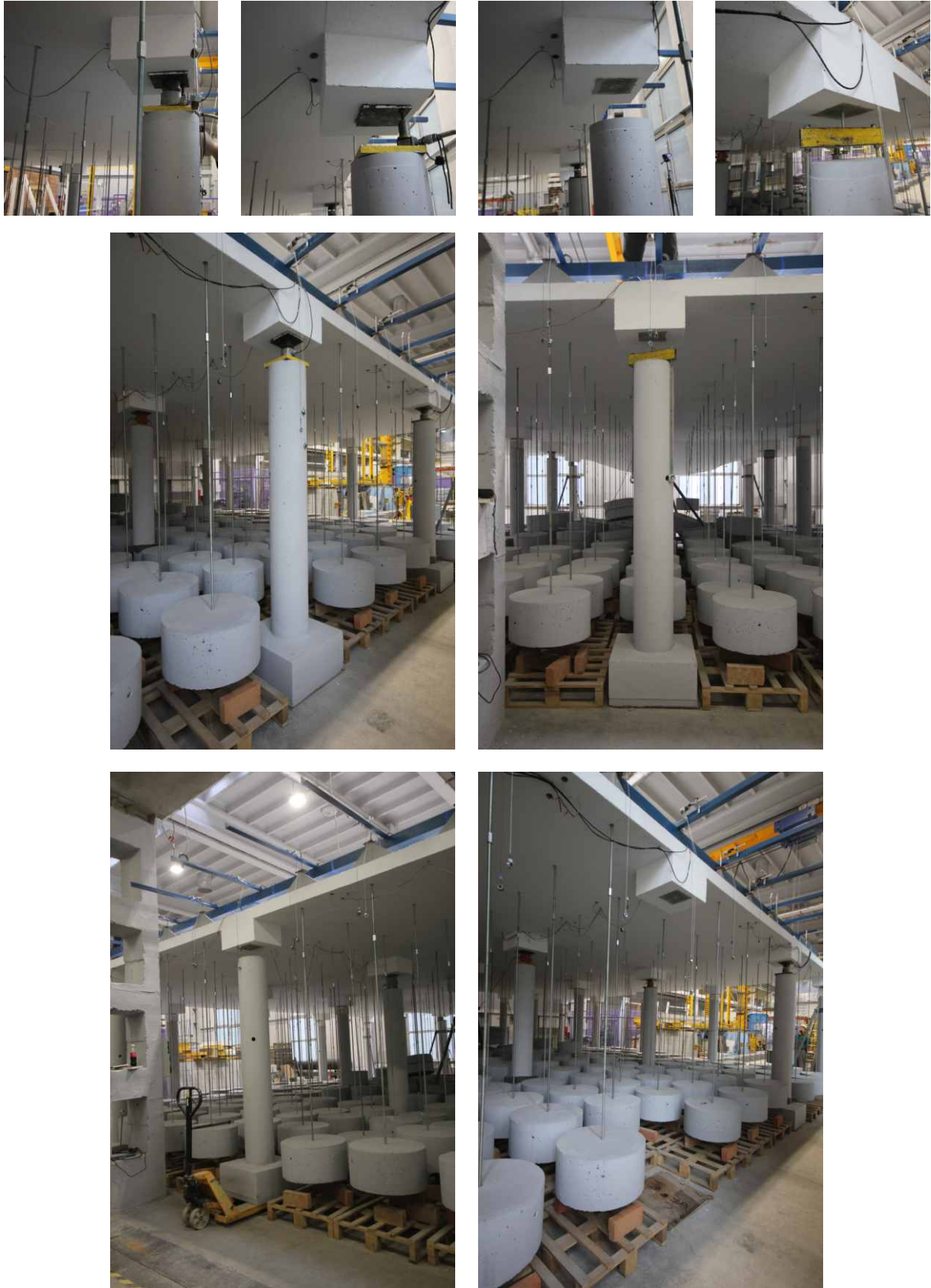
Rys. 51. Przebieg badań – usuwanie podpory
