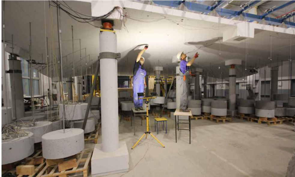
Rys. 54. Przebieg badań – odwzorowywanie zarysowań na dolnej powierzchni płyty
