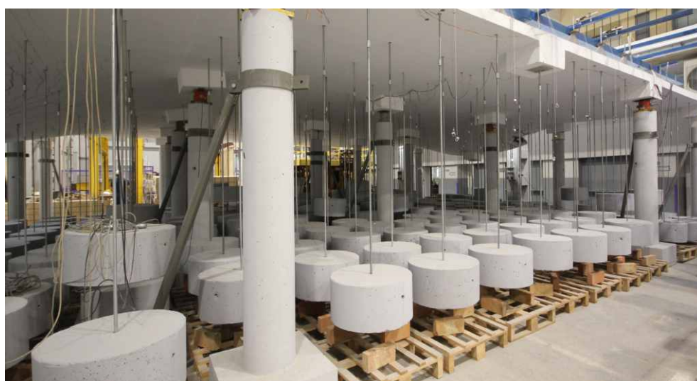
Rys. 52. Przebieg badań – podwieszenie dodatkowego obciążnika w miejscu usuniętego słupa
