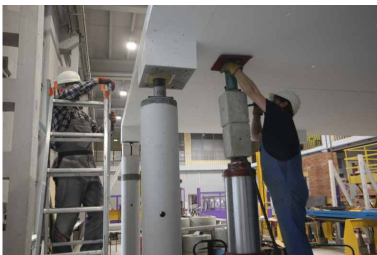
Rys. 49. Przebieg badań – zerowanie siłomierzy
