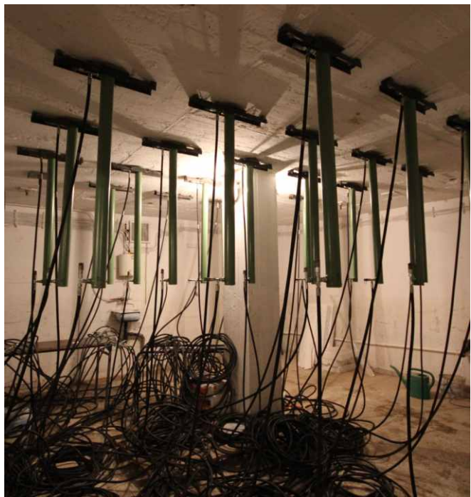
Rys. 30. System obciążania hydraulicznego w drugim etapie badań - obwód wewnętrzny:
