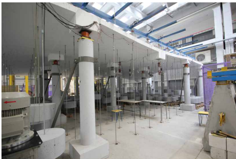
Rys. 59. Przebieg badań – obciążanie modelu do zniszczenia
