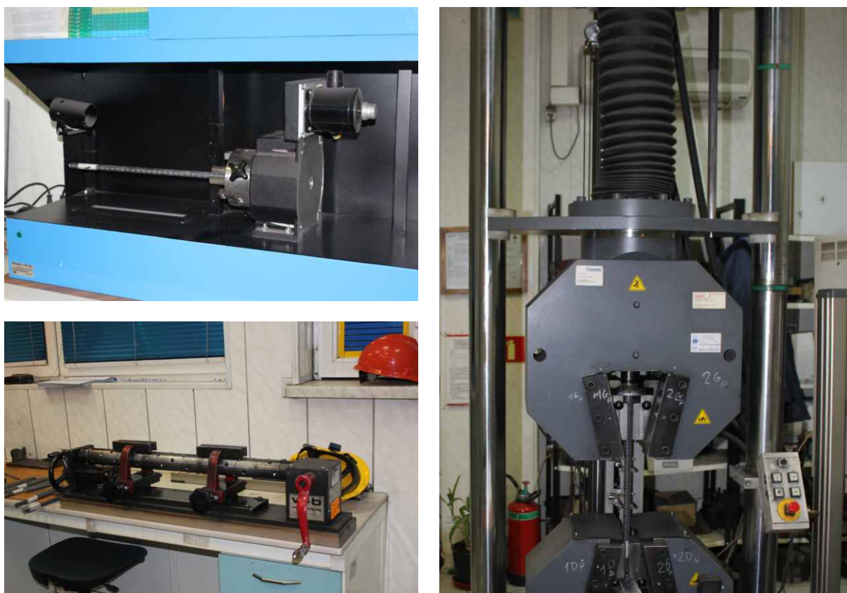
Rys. 44. Widok aparatury do badania parametrów mechanicznych stali [16]
