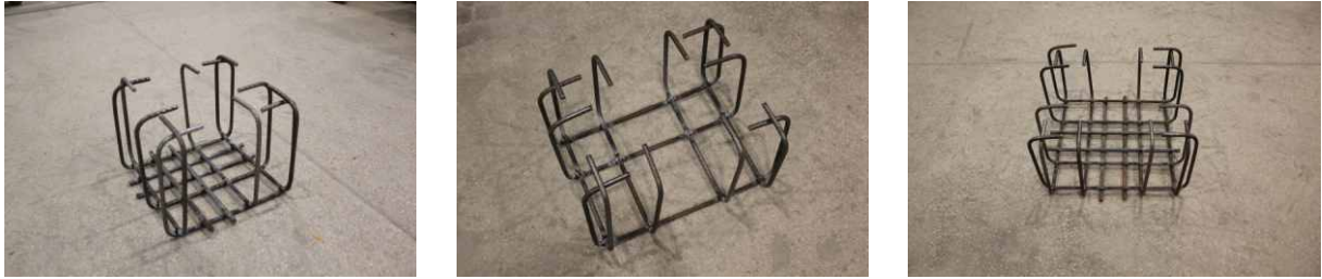
Rys. 14. Widok koszy zbrojeniowych, które zastosowano w głowicach
