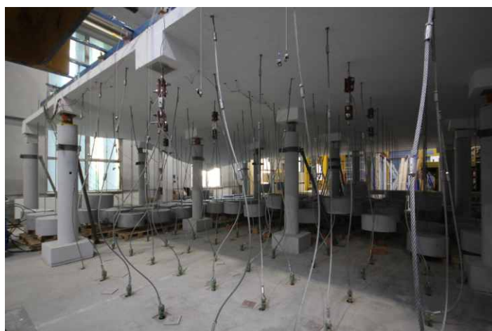
Rys. 29. System obciążania hydraulicznego w drugim etapie badań – obwód zewnętrzny:
