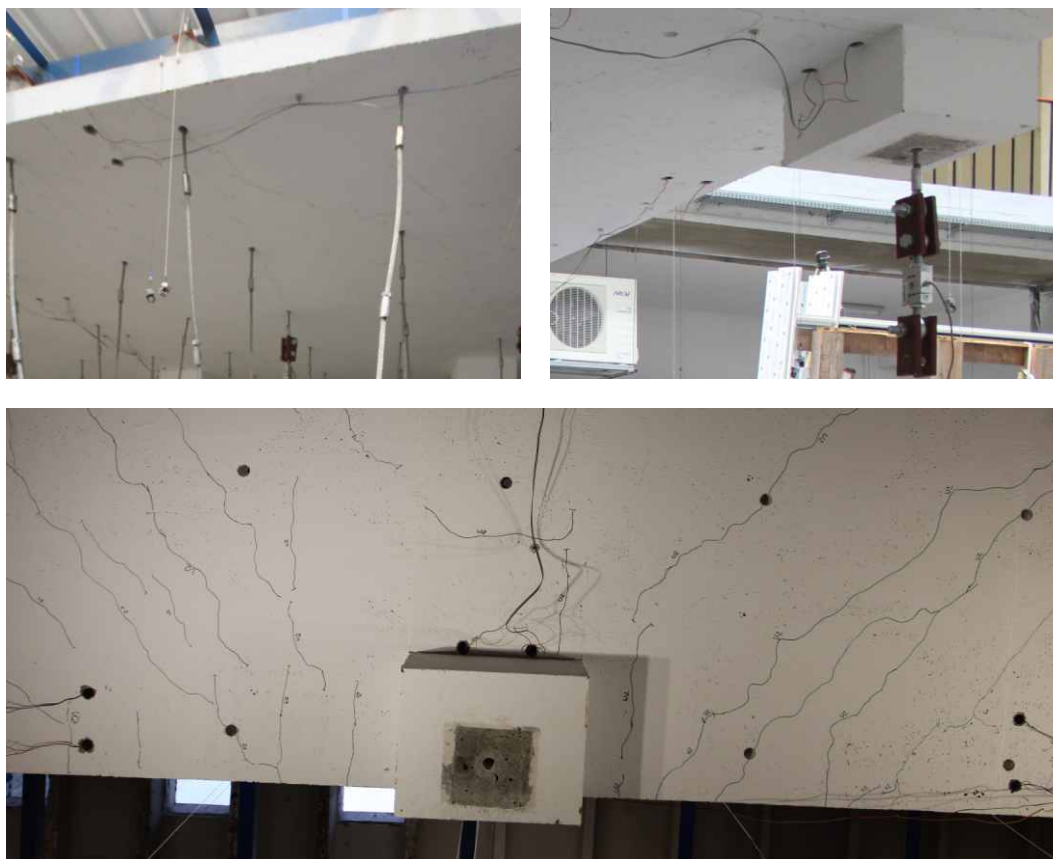
Rys. 66. Widok wyprowadzenia przewodów pomiarowych poza model badawczy
