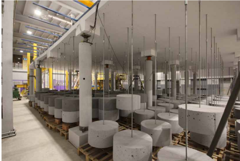
Rys. 57. Przebieg badań – obciążanie modelu obciążeniem 400kg
