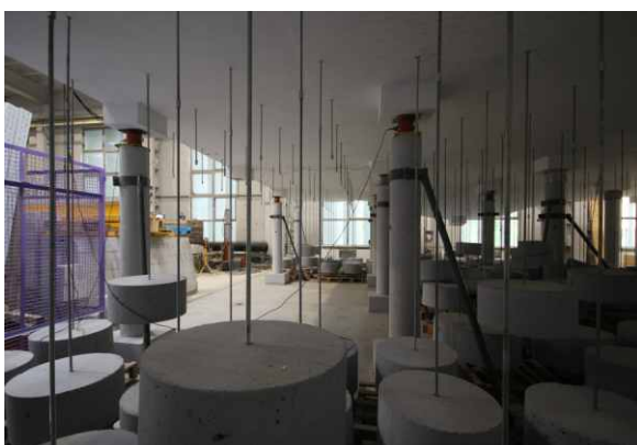
Rys. 27. System obciążania grawitacyjnego:
