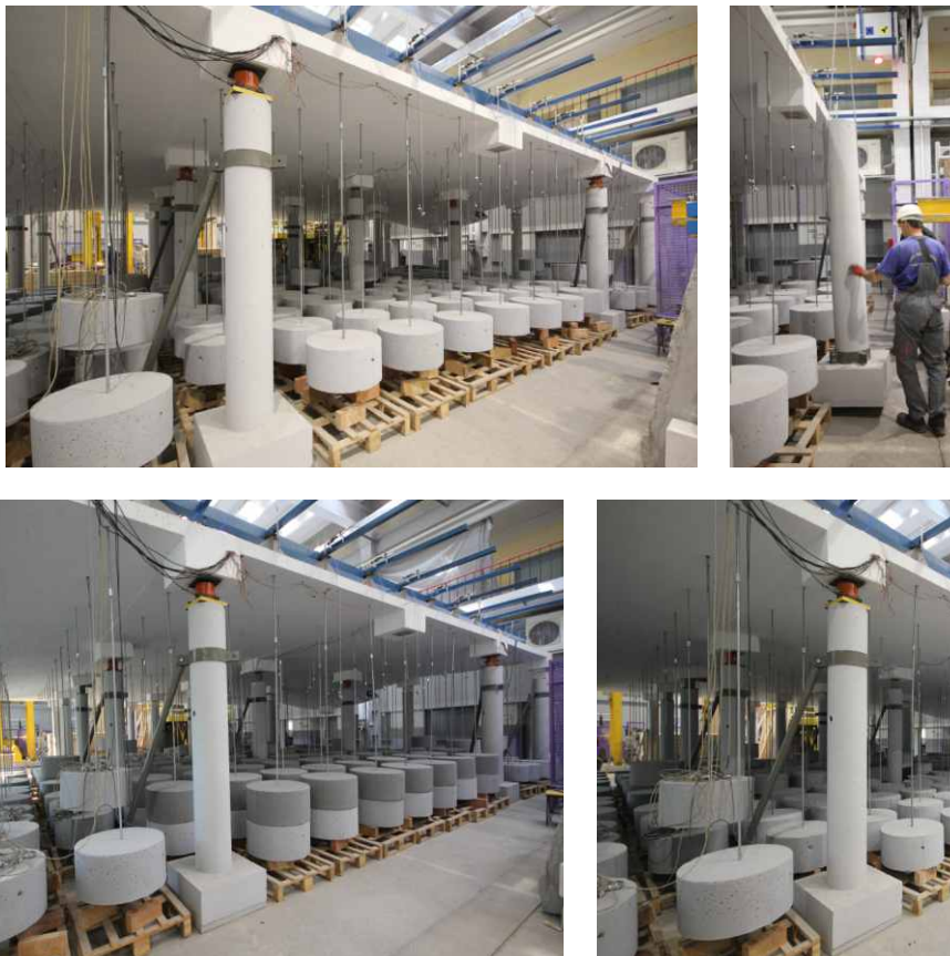
Rys. 28. System obciążania grawitacyjnego w pierwszym etapie badań:
