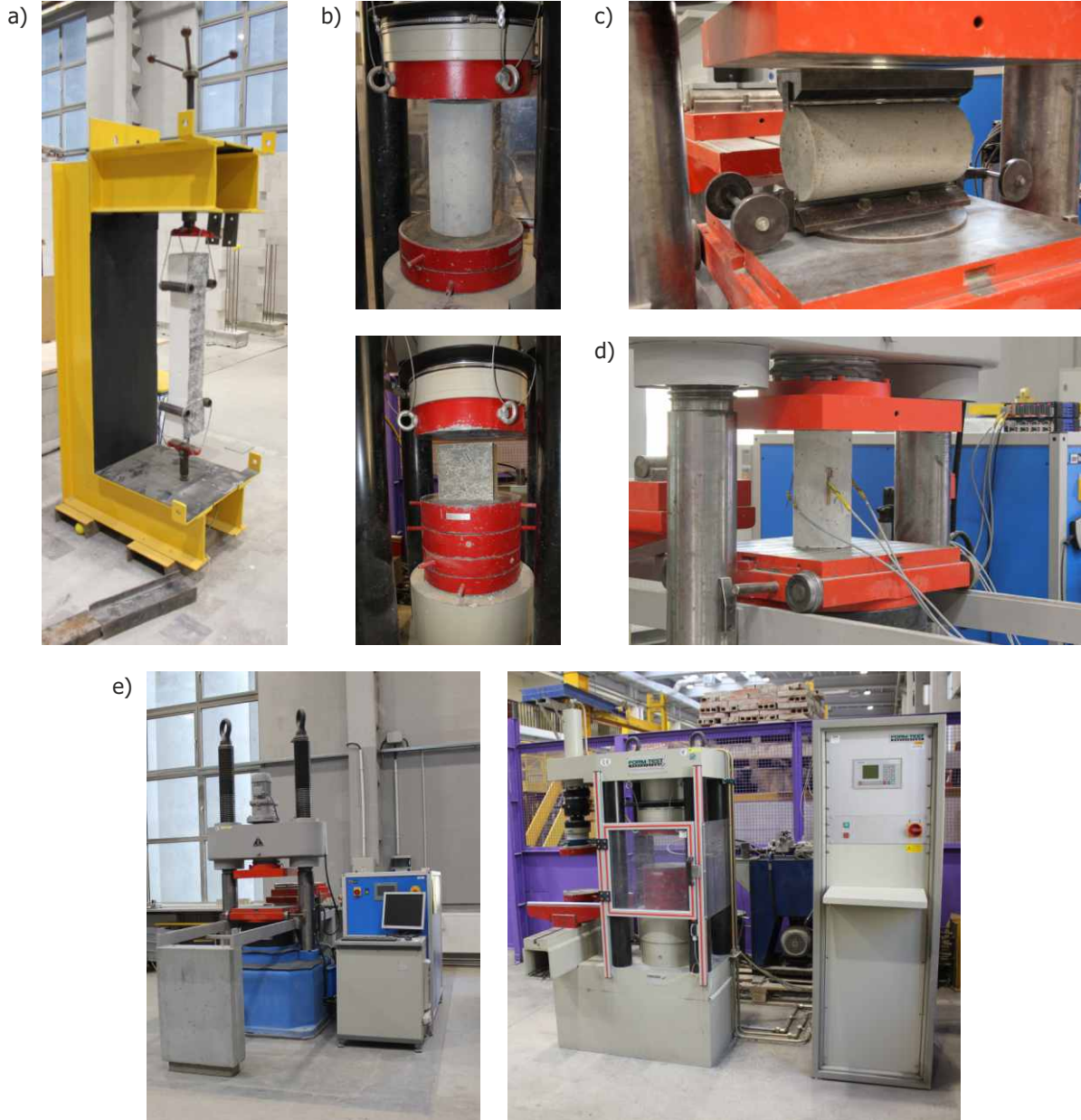
Rys. 46. Badania laboratoryjne: a) badanie wytrzymałości na rozciąganie przy próbie bezpośredniej, b) badanie wytrzymałości na ściskanie, c) badanie wytrzymałości na rozciąganie przez rozłupanie, d) badanie modułu sprężystości, e) aparatury do badań wytrzymałościowych
