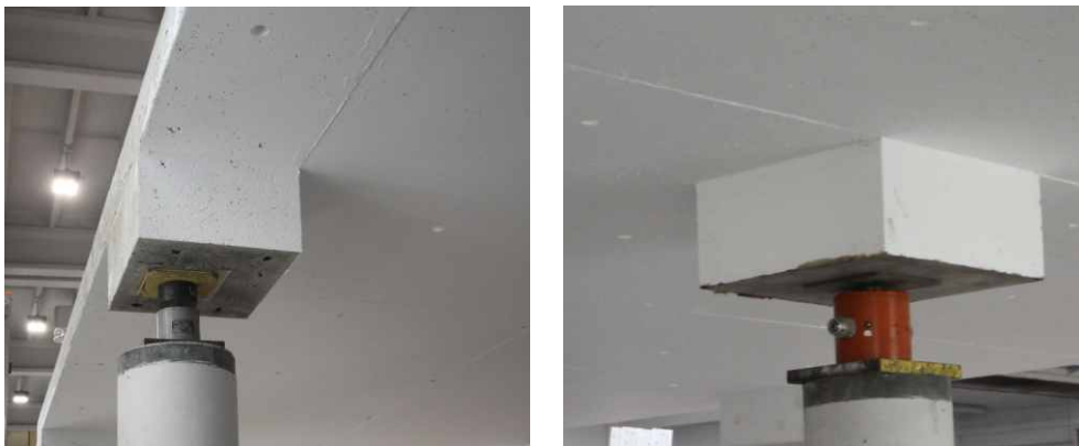
Rys. 63. Widok realizacji pomiarów reakcji podporowych
