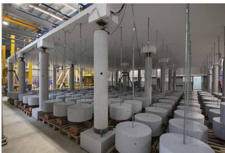
Rys. 50. Przebieg badań – obciążanie modelu obciążeniem 200kg
