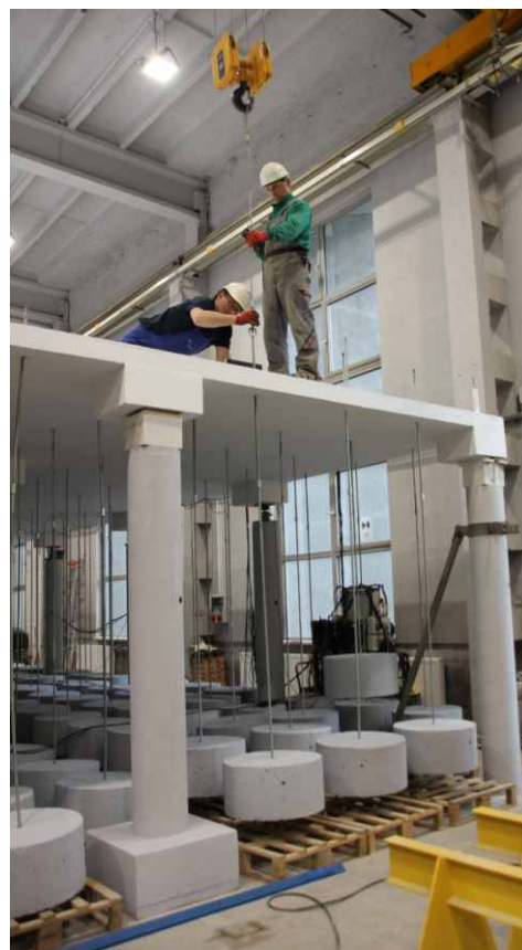
Rys. 27. System obciążania grawitacyjnego:
