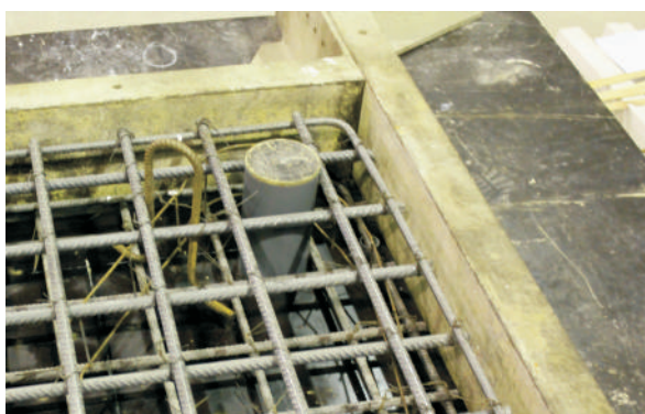
Rys. 16. Przygotowanie modeli badawczych - szczegóły ułożenia zbrojenia modeli w formie.
