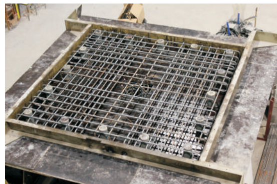
Rys. 15. Przygotowanie modeli badawczych: a) widok deskowania - dolna płyta deskowania z zamontowanymi burtami, słupki kształtujące otwory w płytach, deskowanie słupa, b) transport i widok ułożonego zbrojenia w formie.
