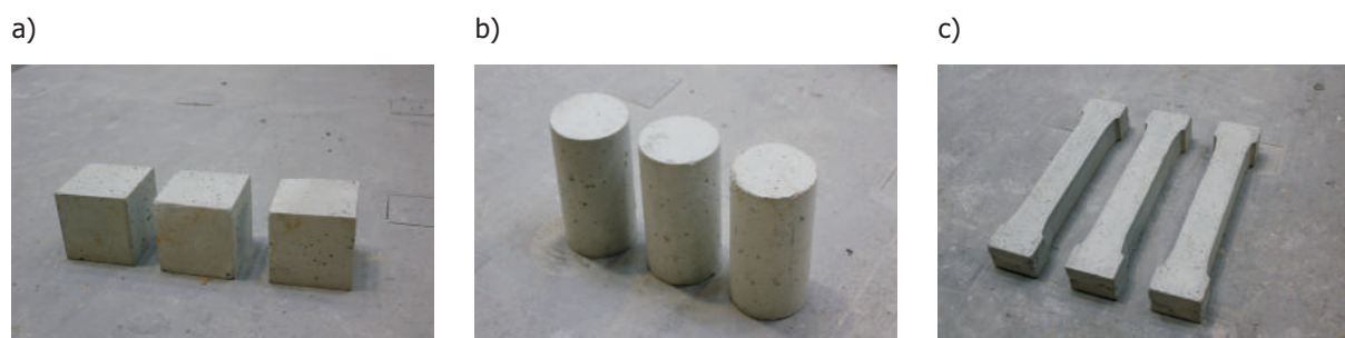
Rys. 20. Widok próbek użytych w badaniach: a) próbki do badania wytrzymałości betonu na ściskanie, b) próbki do badania modułu sprężystości, c) próbki do badania wytrzymałości betonu na rozciąganie.
