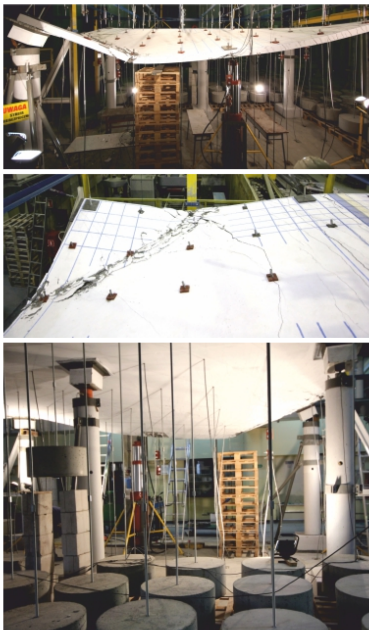
Rys. 15. Widok Modelu 2 po zniszczeniu [39].
