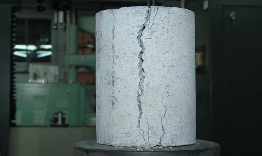
Rys. 12. TYPOWE ZNISZCZENIE PRÓBK W BADANIU „NA ZIMNO”
