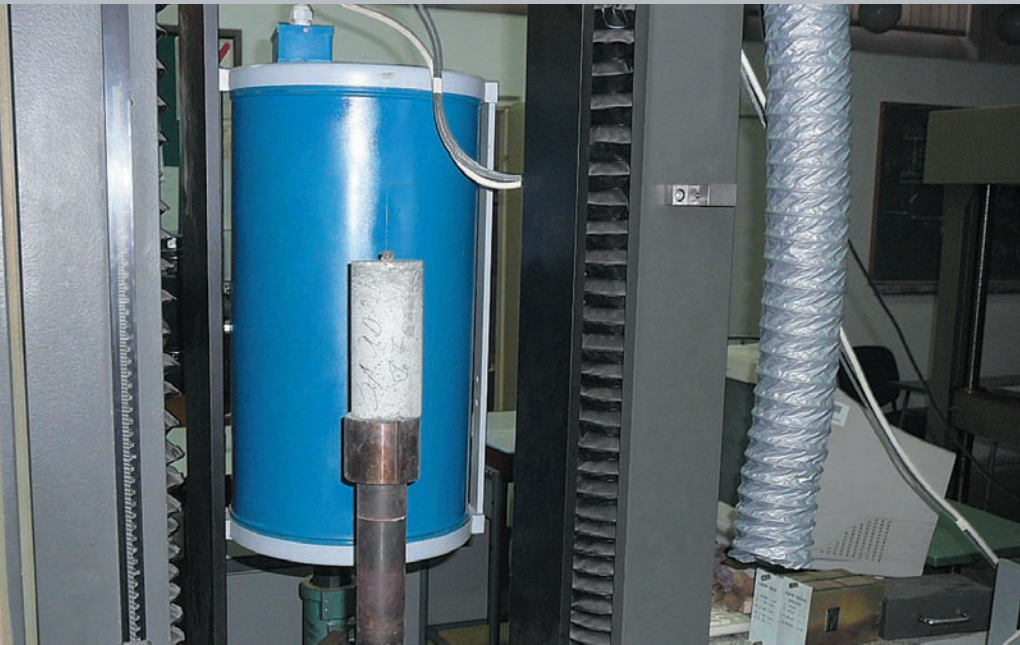
Rys. 13. MODEL BADAWCZY, W TLE CYLINDRYCZNY PIEC, W KTÓRYM WYKONANO TESTY
