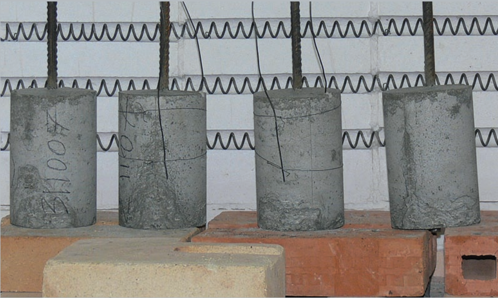
RYS. 11. MODELE BADAWCZE PODDAWANE PODGRZANIU W PIECU
