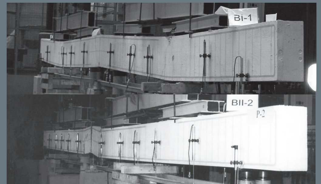
Rys. 16. BELKA ZBROJONA STALĄ EPSTAL PO ZNISZCZENIU
