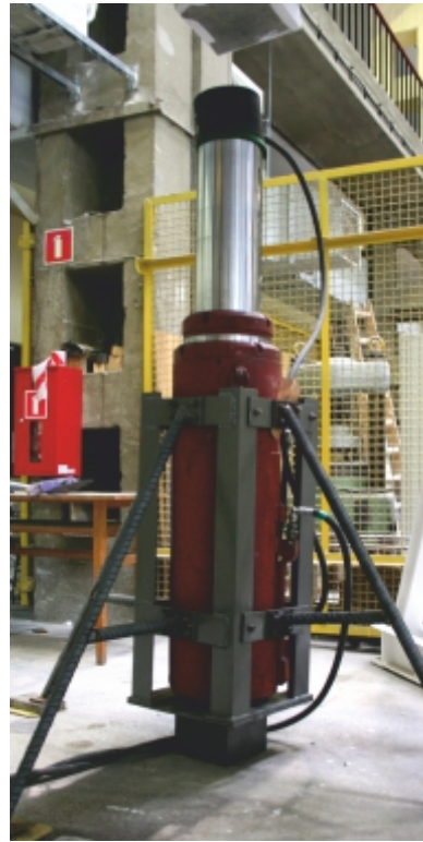
Rys. 22. Szczegół systemu obciążenia hydraulicznego – widok pojedynczego siłownika.
