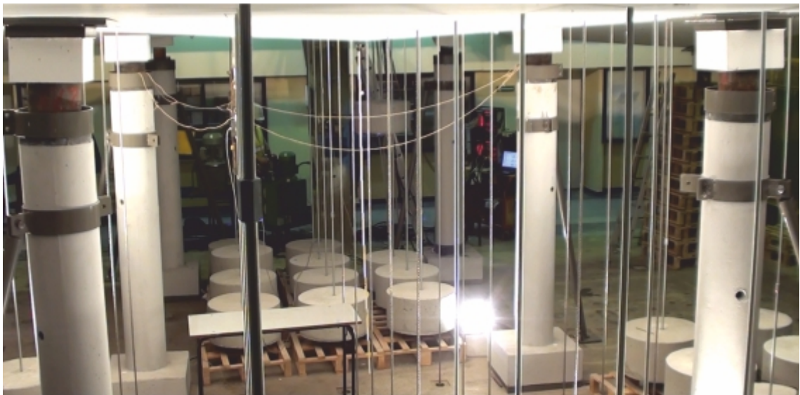
Rys. 37 Widok odkształce Modelu 1 w ostatniej fazie obciążania (obciążenie 44,16 kN na jednej linie).
