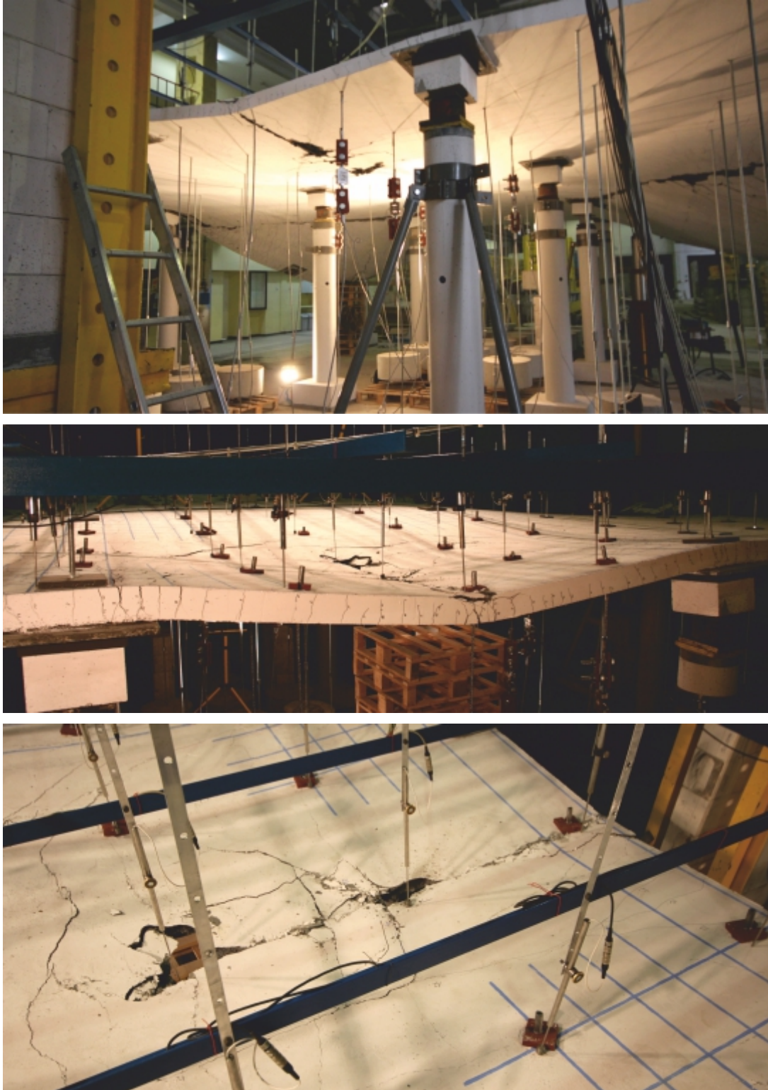
Rys. 38 Widok odkształce Modelu 2 w ostatniej fazie obciążenia (obciążenie 42,83 kN na jednej linie).
