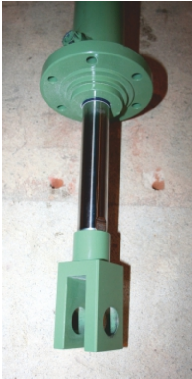
Rys. 22. Szczegół systemu obciążenia hydraulicznego – widok pojedynczego siłownika.
