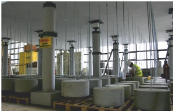
Rys. 23. Szczegół systemu obciążenia grawitacyjnego - widok systemu mocowania obciążenia grawitacyjnego.
