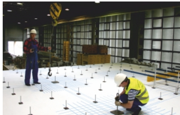
Rys. 23. Szczegół systemu obciążenia grawitacyjnego - widok systemu mocowania obciążenia grawitacyjnego.
