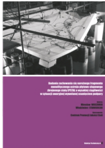
Biuletyn Techniczny nr 4 Badanie zachowania się narożnego fragmentu monolitycznego ustroju płytowo-słupowego zbrojonego stalą EPSTAL o wysokiej ciągliwości w sytuacji awaryjnej wywołanej usunięciem podpory.
